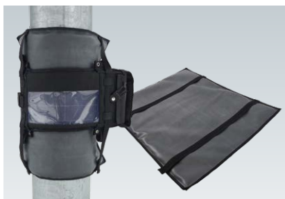
Optionale Hitzeschutzmatte (60 x 52 cm) für Temperaturen bis zu 250 °C, z. B. für die Röntgenprüfung von Rohren während des Betriebs.
