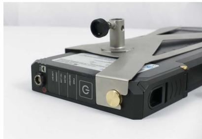
Der Detektor in der Halterung ist nun bereit für den Einsatz, das Batteriefach und die Bedienelemente bleiben zugänglich.
