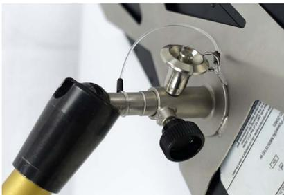
Der Detektor wird auf das Gelenkstativ gesetzt und mit einem Stift gesichert sowie mit einer Schraube arretiert.
