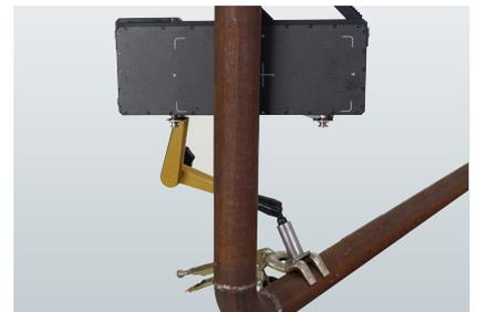
Durch einen Aktionsradius von 420 mm im Raum, ist eine schnelle Neupositionierung, z.B. bei Teilaufnahmen oder einem Wechsel zu einer benachbarten Schweißnaht, ohne Umklemmen der Ellipsenzange möglich.
