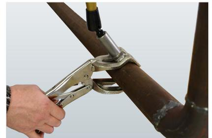
Die Befestigung der Ellipsenzange kann an einem Rohr, aber auch an anderen Objekten, erfolgen.
