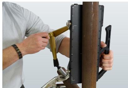
Ist der Detektor in Position, wird das hydraulische Gelenkstativ mittels Drehknopf festgestellt.
