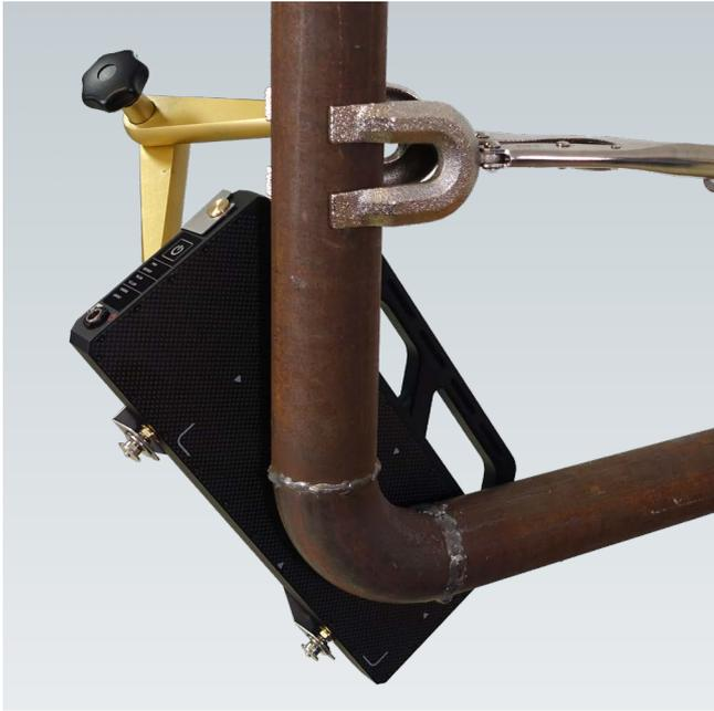
Die Positionierhilfe ermöglicht eine einfache und sichere Platzierung des Detektors DRC 1024 NDT. Durch das Gelenkstativ mit einem Aktionsradius von 420 mm ist der Detektor in wenigen Sekunden in Position, egal ob an einem Rohr ( $\varnothing$  10 mm bis 90 mm) oder einer Platte befestigt.
